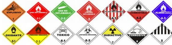
2. Toda carga catalogada como sustancia peligrosa deberá contar con el rombo de identificación según NCh 1411 (NFPA 704)
