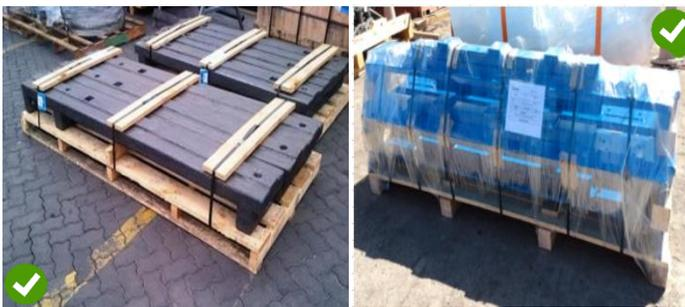
Componente metálico con gomas entre los zunchos que evitan que el zuncho se deslice evitando el movimiento de la pieza.
