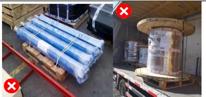
El cartón entre zunchos y piezas metálicas genera deslizamiento por vibración en el traslado, ocasiona que la pieza se suelte.
