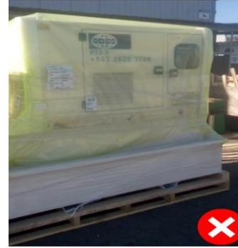
Carga debe indicar puntos de amarra segura para evitar daños a la carga y estar adosada al pallet.
