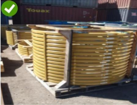
Carga de longitud (tubería) debe tener un paletizado adecuado que asegure estabilidad en la carga y descarga.
