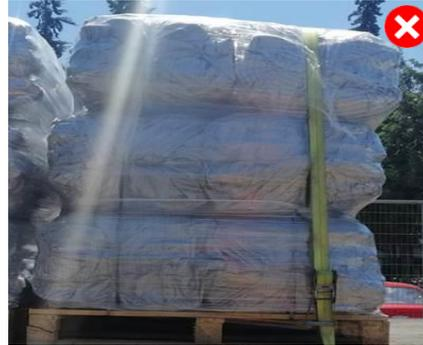
Una tapa adecuada (a medida) toma mayor fuerza dado que funciona como plan B para la protección de la carga, dado que por su naturaleza (sacos tienden a deslizarse), la tapa realizará mayor sujeción evitando daño al material y asegurando la correcta amarra en el transporte.
