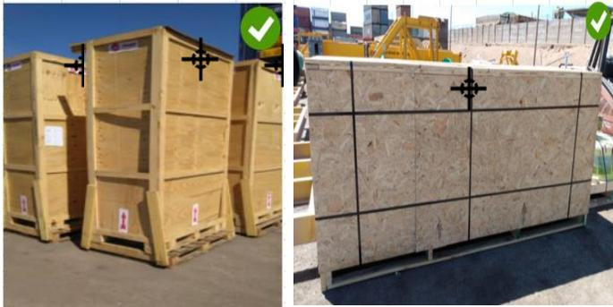
Material 100% dentro del pallet y piezas asegurada correctamente al pallet.
