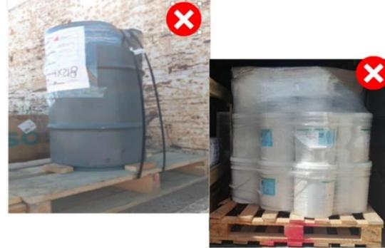
Realizar un apilado considerando la resistencia de los envases, un sobre apilamiento puede dañar los pisos inferiores, generando daños y derrames del material.
