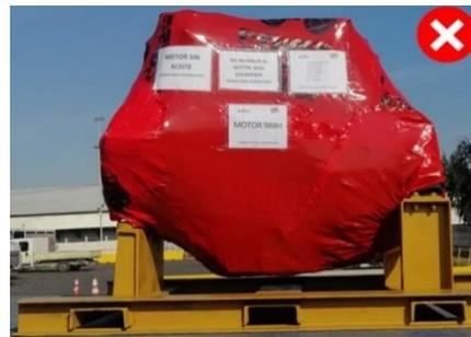
Carga debe indicar puntos de amarra (puntos de sujeción)
