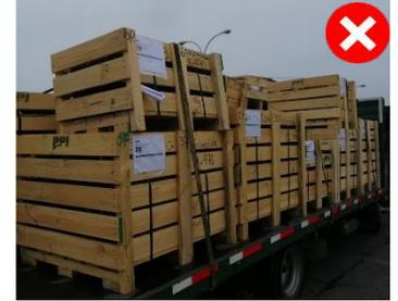
**NO SE RECIBE JABA CORCHETEADAS\* (Se excluye la carga de importación, pasando por una revisión de resistencia con respecto al material que contenga) Y TACOS SOBRE PUESTO A ESTRUCTURA DEL PALLET.**
